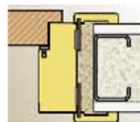
Montaj cu spumă în perete din placă gips-carton
