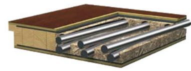
miezul: placă PAL perforat + bare de oțel + placă de aluminiu
