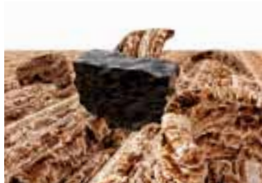
Granule de carbura de siliciu in timpul slefuirii de lemn de esenta tare.
