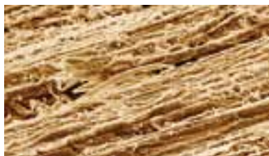
Suprafata lemnului dupa slefuirea cu oxid de aluminiu.
