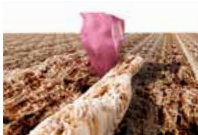
Granule de oxid de aluminiu in timpul slefuirii de lemn de esenta moale.
