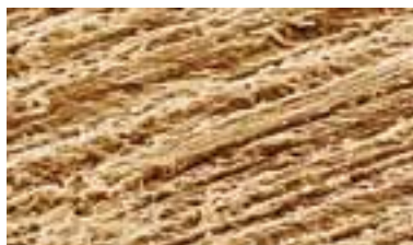
Suprafata lemnului dupa slefuirea cu carbura de siliciu.
