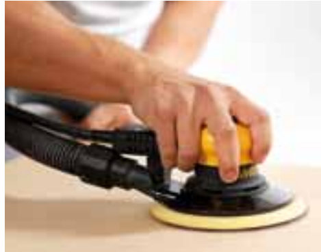
Slefuirea lemnului in conditii normale.
